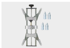
STDA33EU Paire de griffes d'auto-centrage à vis à 4 points de prise, pour jantes de 10" à 24"
