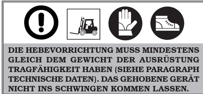
Wenn das Gerät von ihrer normalen Arbeitstellung zu einer anderen bewegt werden muss, so müssen die folgenden Anweisungen beim Transport der Maschine befolgt werden:
