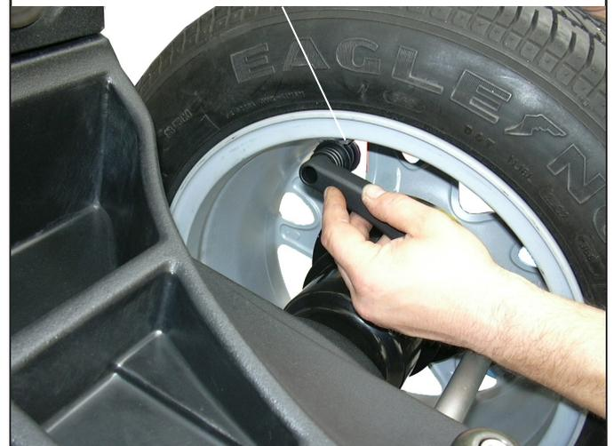
4. portare il braccio del calibro distanza-diametro in posizione di riposo, dopo averlo portato verso il mandrino per sbloccarlo dalla posizione di applicazione peso;
