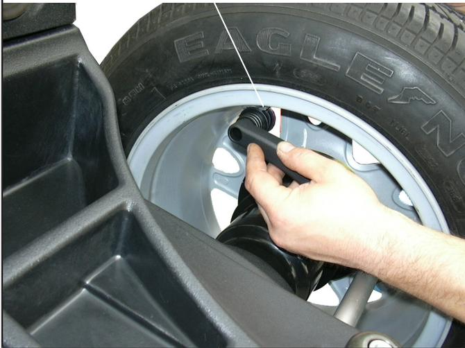
Al termine della procedura è possibile verificare le condizioni di equilibratura della ruota, effettuando un ulteriore lancio di controllo.
