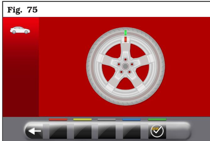
**PASSO 1.** Portare la freccia presente sulla flangia a "ore 12". Marcare un segno di riferimento, usando ad esempio un gesso, sul cerchio e sul pneumatico in corrispondenza della freccia presente sulla flangia, in modo da poter rimontare il cerchio nella medesima posizione sull'apparecchiatura.
