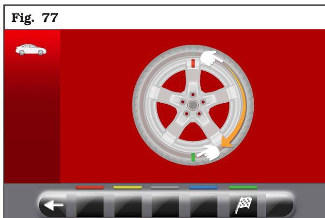
**PASSO 2.** Togliere la ruota dall'equilibratrice. Smontare il pneumatico e ruotarlo sul cerchio di 180 gradi.
