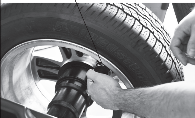
Das Gewicht in der Position anbringen, in der die Gewichtsklemmzange das Rad berührt Abb. 46
