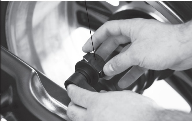
Abb. 45 Das Klebegewicht in die Zange des Tasterstabs einsetzen
