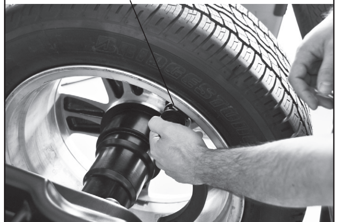
Abb. 39 Das Gewicht in der Position anbringen, in der die Gewichtsklemmzange das Rad berührt
