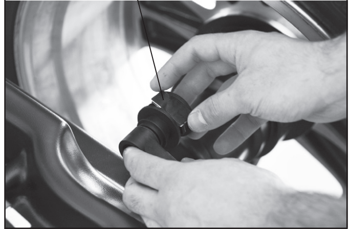
Abb. 38 Das Klebegewicht in die Zange des Tasterstabs einsetzen
