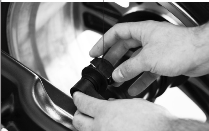
Abb. 32 Das Klebegewicht in die Zange des Tasterstabs einsetzen
