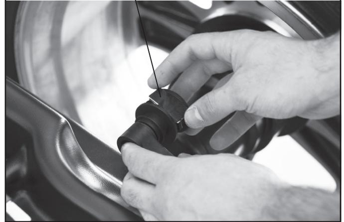
Il fatto che la posizione di applicazione del peso non è esattamente ad "ore 12" (**Fig. 39**) viene compensato automaticamente.
