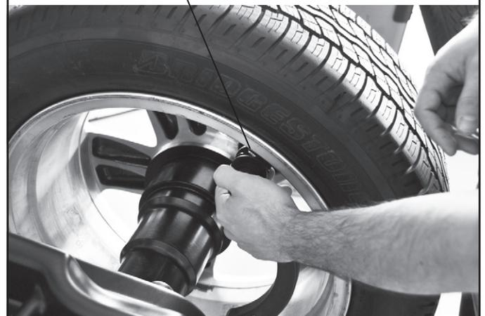
Al termine della procedura è possibile verificare le condizioni di equilibratura della ruota, effettuando un lancio di controllo.
