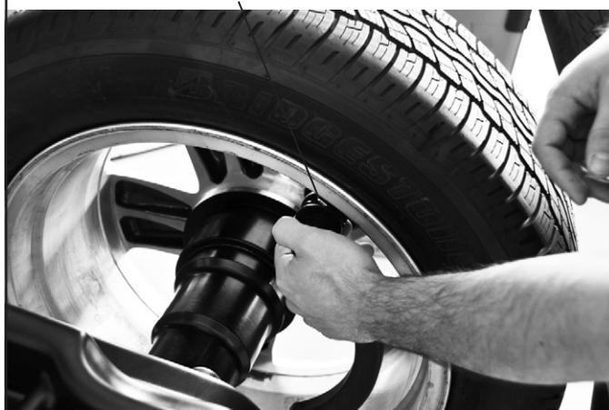
Portare il braccio del calibro distanza-diametro in posizione di riposo.
