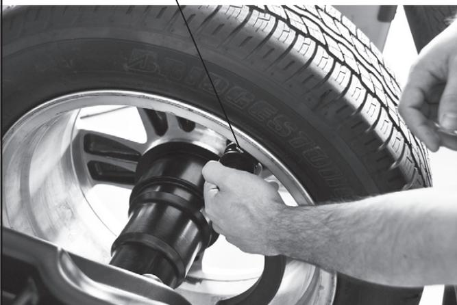
Al termine della procedura è possibile verificare le condizioni di equilibratura della ruota, effettuando un lancio di controllo.
