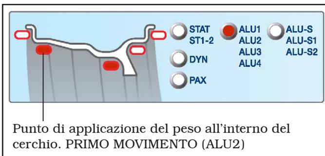
La funzione ALU3 è una procedura che usa pesi misti per compensare lo squilibrio della ruota: peso con molletta sul lato interno della ruota, peso adesivo a "ore 12" sul lato esterno, non visibile perché all'interno del cerchio.
