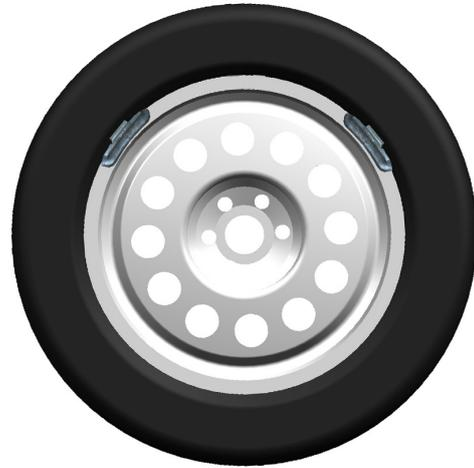
Die Messwertanzeige der "DYNAMISCHEN" Unwucht erhalten Sie indem Sie einen normalen Radmesslauf durchführen.
