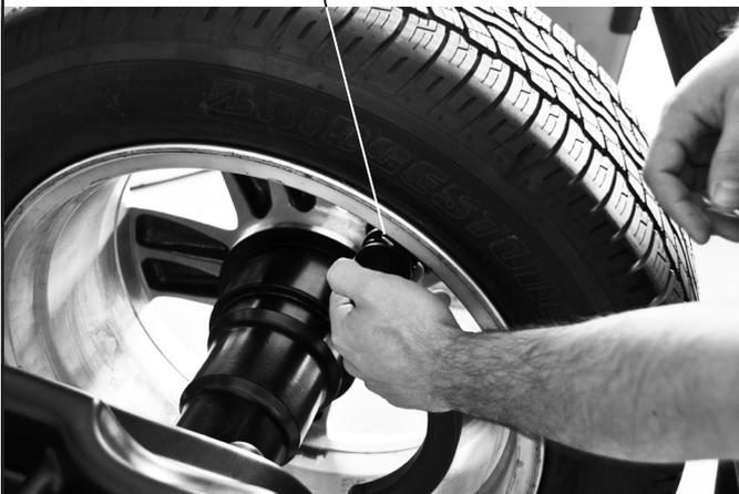
Am Ende des Auswuchtverfahrens können die Auswuchtbedingungen des Rads innerhalb eines Kontrollmessdurchgangs überprüft werden. Das Auswuchtverfahren "ECO-WEIGHT" ist damit abgeschlossen.
