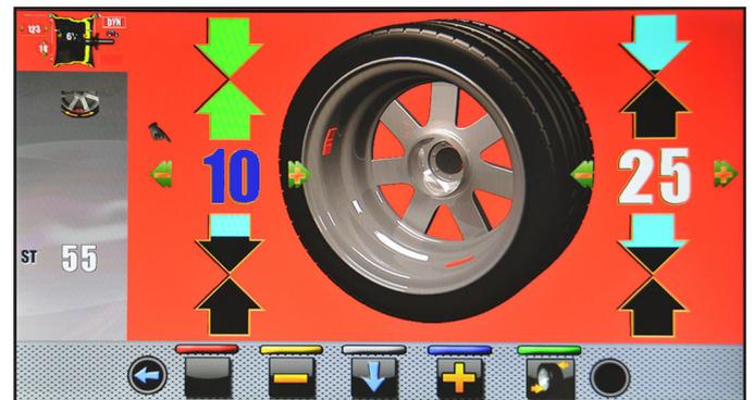
Wiederholen Sie die beschriebene Operationen für die Gewichte, die innerhalb des Rads aufgebracht werden. Am Ende machen einen Kontrollmesslauf, um zu prüfen, dass Sie die Gewichte richtig angewendet haben.
