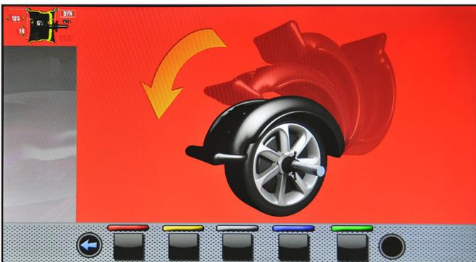
Nach erfolgter Montage des Rads, schließen Sie die Radschutzhaube und starten einen automatischen Messdurchlauf.
