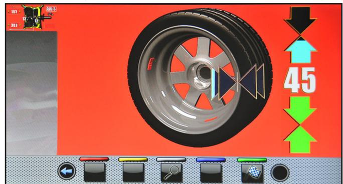
Den Tasterstab herausziehen und bringen das ERSTE Gewicht in der von der Maschine angegebenen Position,
