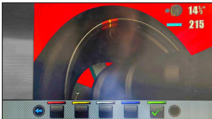
Kontakt herstellen zwischen dem Greifer zur Anwendung des Tastergewichts und dem vorher angewandten Klebegewicht, das Rad auch manuell drehen und Sie passen auf, dass das Rad Kontakt mit dem Mittelteil des Gewichtes hat (siehe **Abb. 63**).
