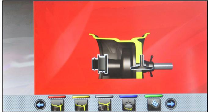
Die Greifzange des Abstand-Durchmesserstasters (**Abb. 40 Pkt. 1**) auf der Innenseite der Felge bringen, wie in **Abb. 40**.
