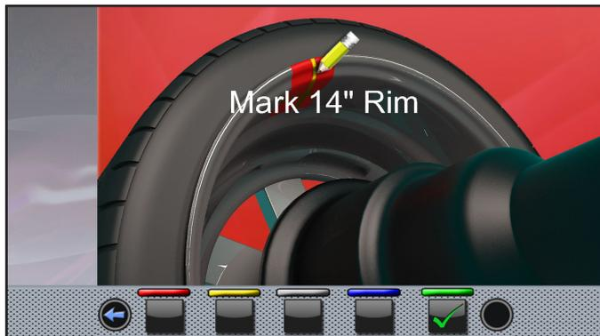
Die Spindel auf das kleine Rad (13"/14" Durchmesser) montieren und ein Klebegewicht in einem irgendeinem Punkt innerhalb der Felge. Am Ende des Verfahrens
