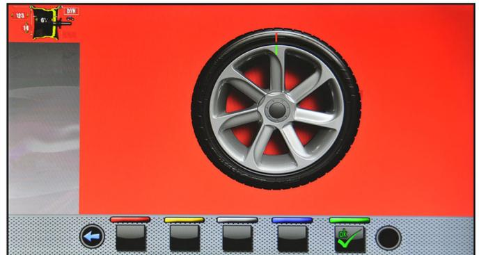
**SCHRITT 1.** Bewegen Sie die Pfeile auf dem Flansch an der "12 Uhr". Markieren Sie sich z.B. mit Kreide einen Anhaltspunkt der Felgen- und Reifenposition, die mit dem Pfeil am Flansch übereinstimmen muss, so dass Sie später die Felge wieder in der gleichen Position auf die Maschine spannen können.
