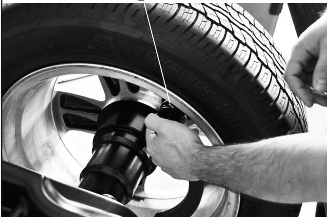
4. Den Arm des Abstand-Durchmesserstasters in Ruhestellung bringen, nachdem es in Richtung der Spindel gebracht wurde, um es von der Position der Anwendung des Gewichtes zu entriegeln.
