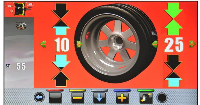
Das Klammengewicht mit dem gewählten Wert bei "12 Uhr" Außenseite des Rads anbringen. Drücken Sie die
