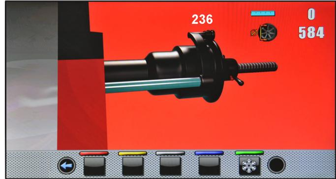
Den Taster (Abb. 59 Pkt. 1) auf die Spindelflansch (Abb. 59 Pkt. 2) stellen.
