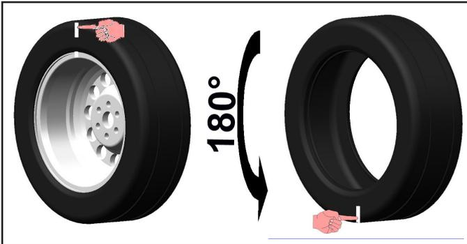
Spannen Sie das Rad erneut auf die Radauswuchtmaschine und richten Sie dabei den markierten Anhaltspunkt der Felge dem Pfeil am Flansch gegenüber aus.
