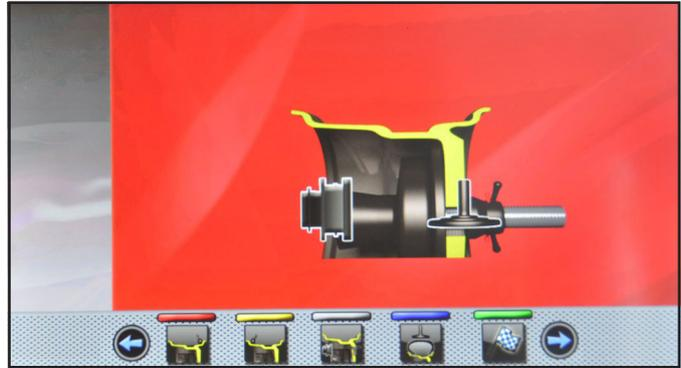
Posicionar la pinza del calibre distancia-diámetro (**Fig. 40 ref. 1**) en el lado interno de la llanta, como indicado en **Fig. 40**.
