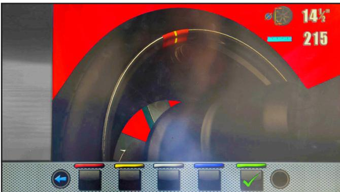
Poner en contacto la pinza de aplicación del peso del palpador con el peso adhesivo aplicado anteriormente, girando manualmente también la rueda y poniendo atención a ponerla en contacto con la parte central del peso (véase Fig. 63).
