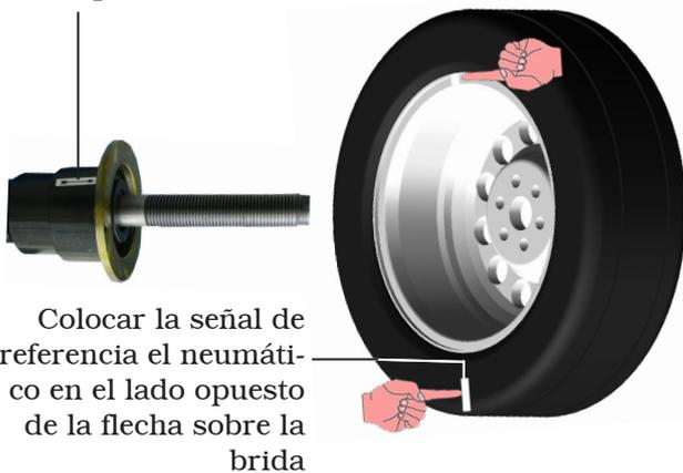
Colocar la señal de referencia el neumático en el lado opuesto de la flecha sobre la brida
