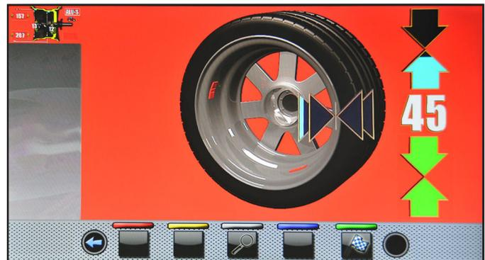
Extraer el eje del palpador y aplicar el PRIMERO peso en la posición indicada por la máquina, como se explica
