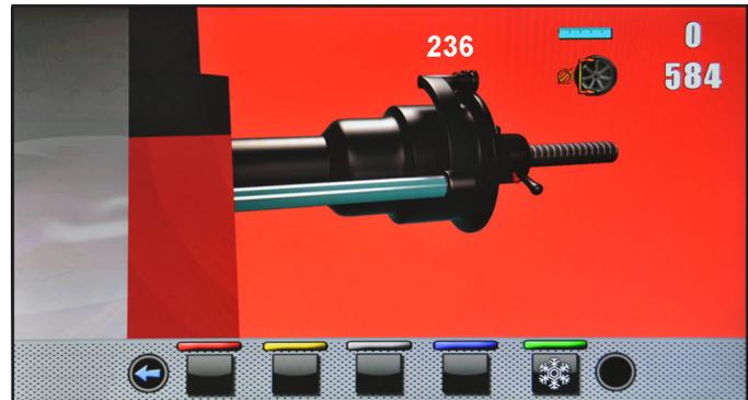
Posicionar el palpador (Fig. 59 ref. 1) sobre la brida del mandril (Fig. 59 ref. 2).
