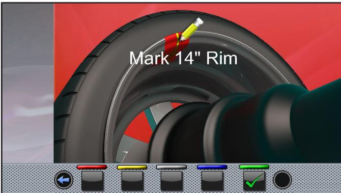
Montar sobre el mandril la rueda pequeña (diámetro 13"/14") y aplicar un peso adhesivo en un cualquier punto en el interior de la llanta. Al final de la operación
