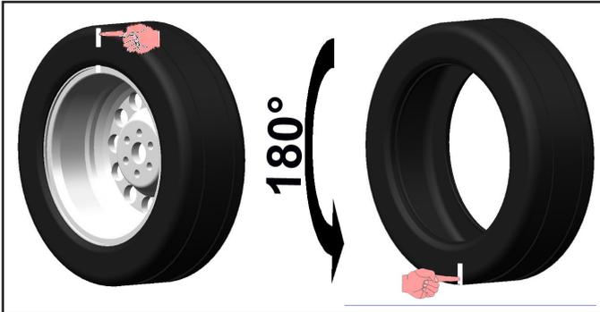
Montar nuevamente la rueda en la equilibradora colocando la señal de referencia de la llanta en correspondencia de la flecha en la brida.
