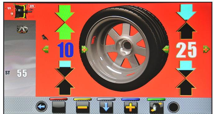
Repetir las operaciones descritas anteriormente para los pesos a aplicar en el interior de la rueda. Al final efectuar nuevamente un balanceo de control para verificar de haber aplicado los pesos correctamente.
