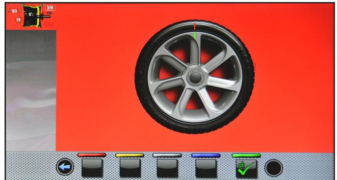
**PASO 1.** Llevar la flecha presente sobre la brida a "horas 12". Marcar una línea de referencia, usando, por ejemplo una tiza, sobre la llanta y sobre el neumático en correspondencia de la flecha presente sobre la brida, para poder montar nuevamente la llanta en la misma posición en la máquina.
