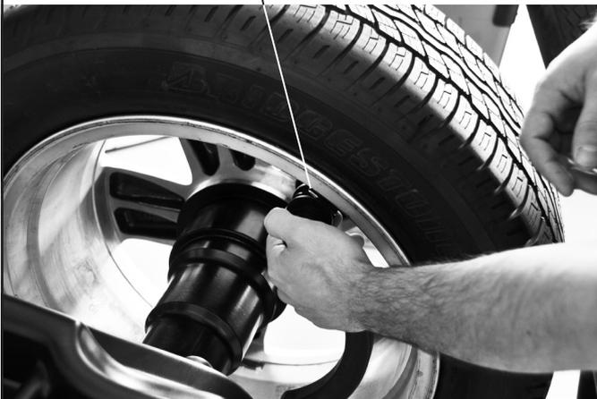
Al finalizar el procedimiento es posible controlar las condiciones de equilibrado de la rueda, realizando un ulterior balanceo de control.
