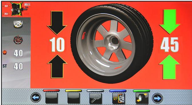
Después de la detección de los valores de desequilibrio, verificar que la máquina visualice la posibilidad de utilizar la opción “radios” (Fig. 43 ref. 4b).
