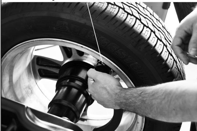
4. Llevar el brazo del calibre distancia-diámetro en posición de reposo, después de haberlo llevado hacia el mandril para desbloquearlo de la posición de aplicación peso.
