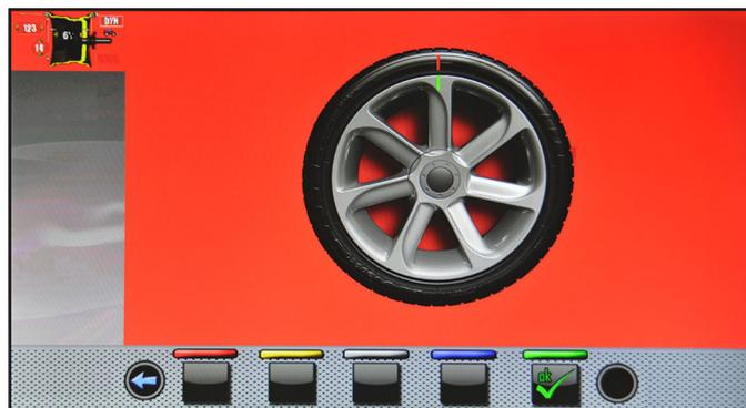
**PASSO 1.** Portare la freccia presente sulla flangia a "ore 12". Marcare un segno di riferimento, usando ad esempio un gesso, sul cerchio e sul pneumatico in corrispondenza della freccia presente sulla flangia, in modo da poter rimontare il cerchio nella medesima posizione sulla macchina.
