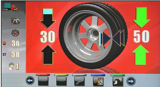
Esiste la possibilità di applicare un singolo peso ad una distanza predeterminata dalla macchina, in maniera da ottimizzare il consumo di pesi, riducendo il più possibile sia lo squilibrio DINAMICO che l'eventuale residuo STATICO.
