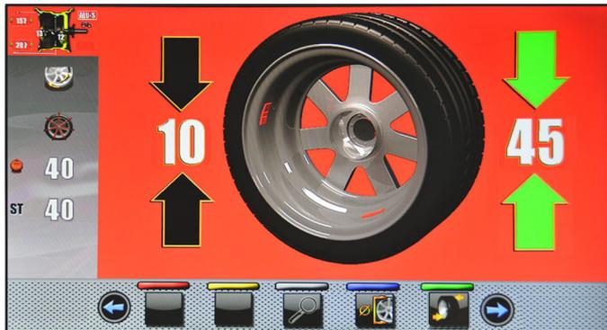
Una volta rilevati i valori di squilibrio, verificare che la macchina visualizzi la possibilità di utilizzare l'opzione “razze” (Fig. 43 rif. 4b).
