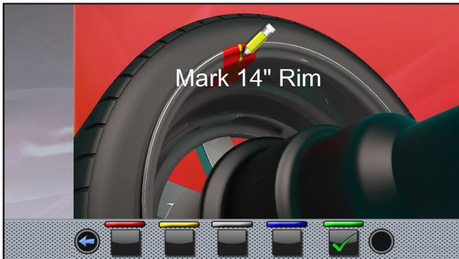
Montare sul mandrino la ruota piccola (diametro 13"/14") e applicare un peso adesivo in un punto qualsiasi all'interno del cerchio. Al termine dell'operazione
