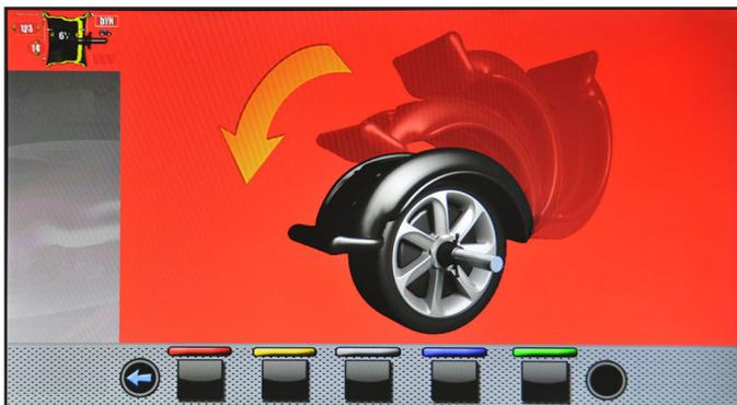
Dopo aver rimontato la ruota, chiudere il carter di protezione per eseguire il lancio automatico. Al termine del lancio sul monitor verrà visualizzata la seguente videata:
