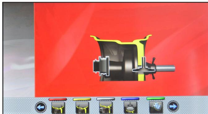
Posizionare la pinza del calibro distanza-diametro (**Fig. 40 rif. 1**) sul lato interno del cerchio, come indicato in **Fig. 40**.
