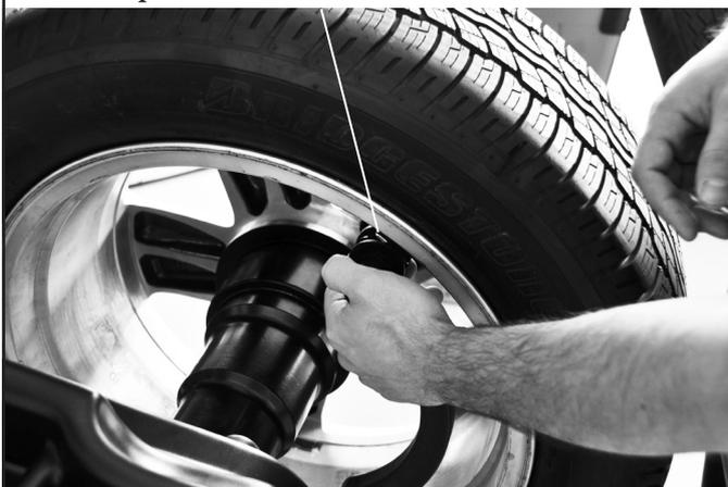
4. Portare il braccio del calibro distanza-diametro in posizione di riposo, dopo averlo portato verso il mandrino per sbloccarlo dalla posizione di applicazione peso.
