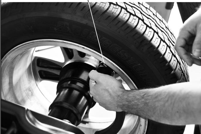
Al termine della procedura è possibile verificare le condizioni di equilibratura della ruota, effettuando un ulteriore lancio di controllo.
