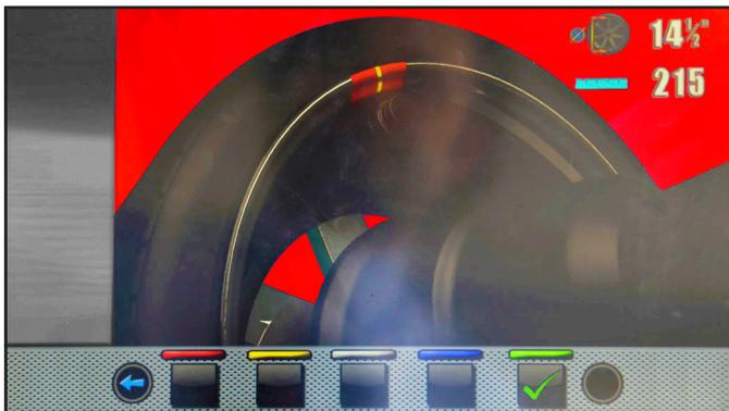
Portare a contatto la pinza di applicazione del peso del calibro con il peso adesivo applicato in precedenza ruotando manualmente anche la ruota e facendo attenzione a portarla a contatto con la parte centrale del peso (vedi Fig. 63).
